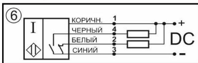
Схема соединения Переключающий контакт
